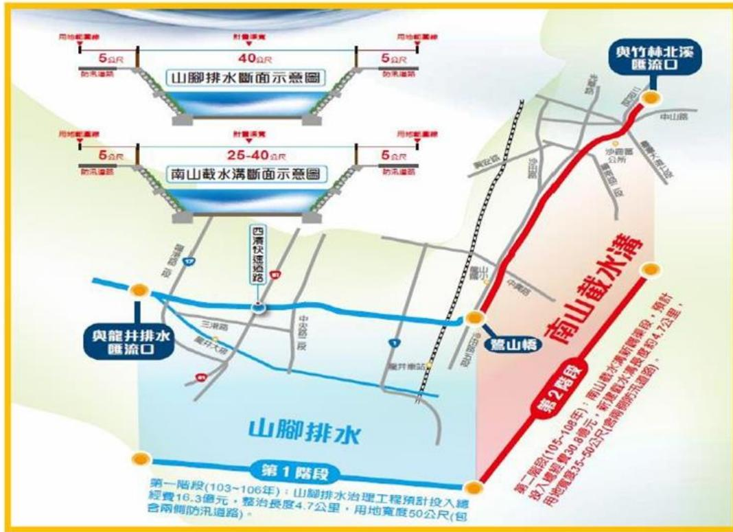
說明：整治工程由下游山腳排水起分兩大渠段進行，分別為山腳排水(排水起點至上游鷺山橋)及鷺山橋上游新闢渠道段。山腳排水段於 105 年 4 月 14 日已開工。
